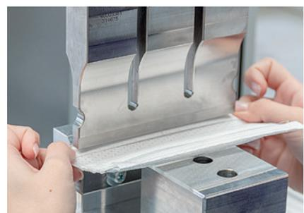
3. Soldadura horizontal por ultrasonido de las costuras transversales 1 y 2. La cinta de fijación de la nariz se coloca manualmente (sin imagen).
