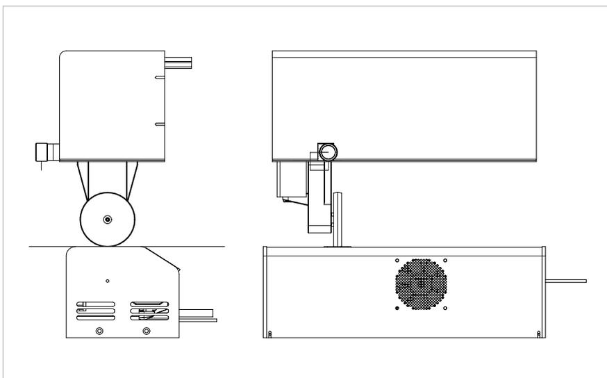
具焊接和切割功能的双轴辊焊头
