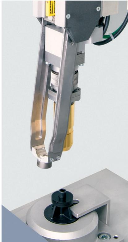
通过加热时间的设定对铆柱加热，结束后红外灯罩退出工位
