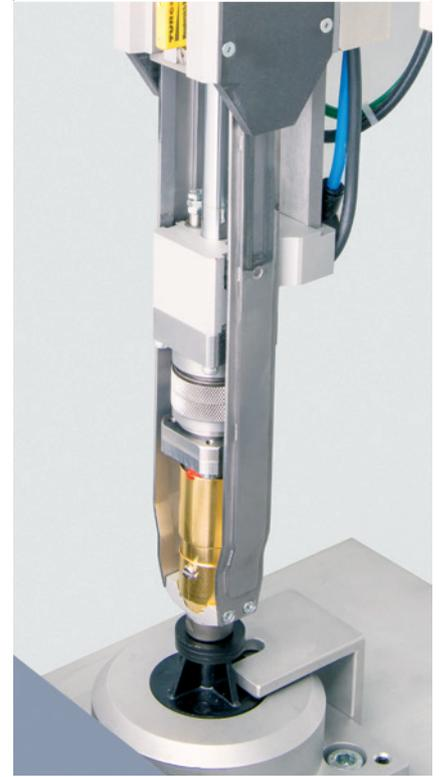
执行机构将压头送入工作位，压头进行冲压塑形
