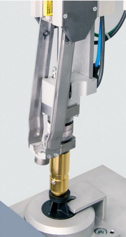
镀金的聚焦灯罩由红外执行机构送至铆点位置，将红外辐射热能聚焦到铆柱上
