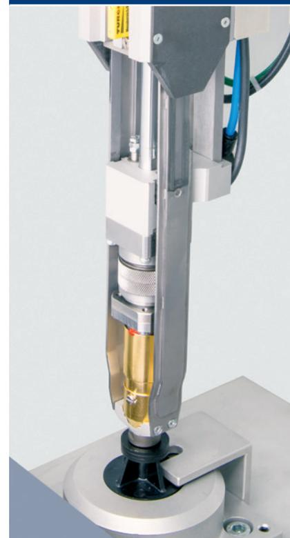
La unidad de avance de infrarrojos con el dispositivo de estampado predoblado se desplaza a la cúpula de remaches calentados para el estampado.
