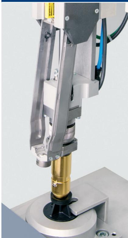
La unidad de avance de infrarrojos con emisor extendido emite una radiación focalizada en la cúpula del remache.
