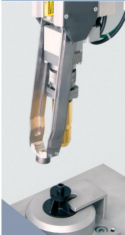
Infrarot-Vorschubeinheit fährt den Strahler ein und anschließend die Prägevorrichtung aus, um den Prägevorgang einzuleiten.
