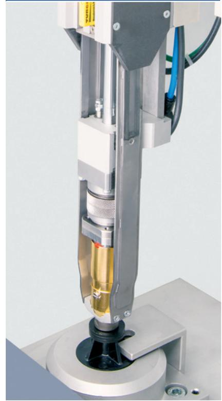
Infrarot-Vorschubeinheit mit vorgeklappter Prägevorrichtung fährt zum Prägen an den erwärmten Nietdom.
