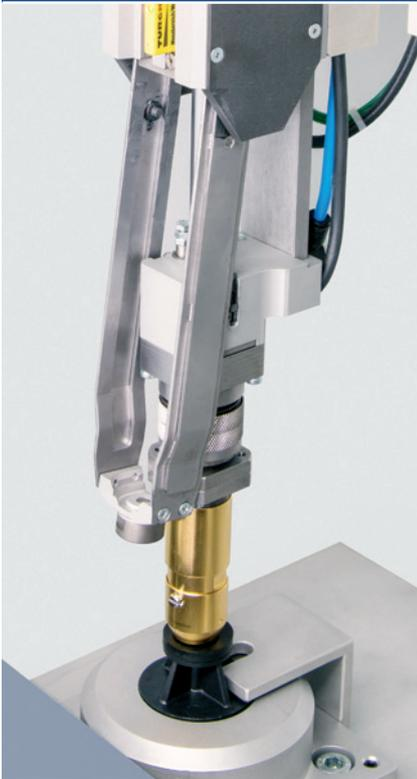
Infrarot-Vorschubeinheit mit ausgefahrenem Strahler gibt fokussierte Strahlung in den Nietdom ab.
